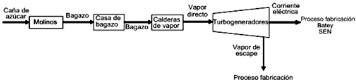
Figura 1. Esquema de generación del central azucarero Héctor Rodríguez.
